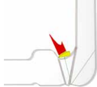
Pièce comportant deux génératrices et un défaut plan type fissure au pied de la soudure. Profil de pièce complexe, ce qui rend le capteur inadapté à la surface de la pièce.
