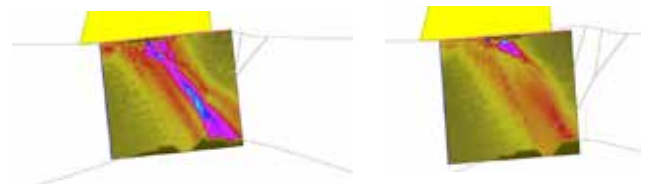
Calcul du champ ultrasonore selon deux positions mécaniques.
