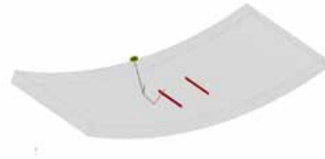
Peça comportando dois defeitos na parede externa: aberto e não aberto.
