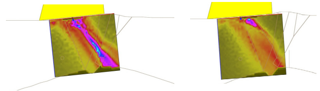
Calcolo del campo ultrasonoro secondo due posizioni meccaniche.
