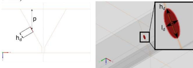
Figure 1 - Positionnement du manque de fusion. A gauche : vue en coupe du défaut dans le plan (Oxz). A droite : vue 3D de la soudure bout-à-bout (chanfrein en « V ») et du défaut.
