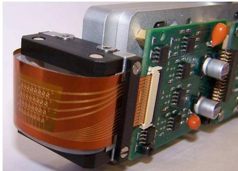
Figure 4 : Sonde CF multi-éléments flexibles
