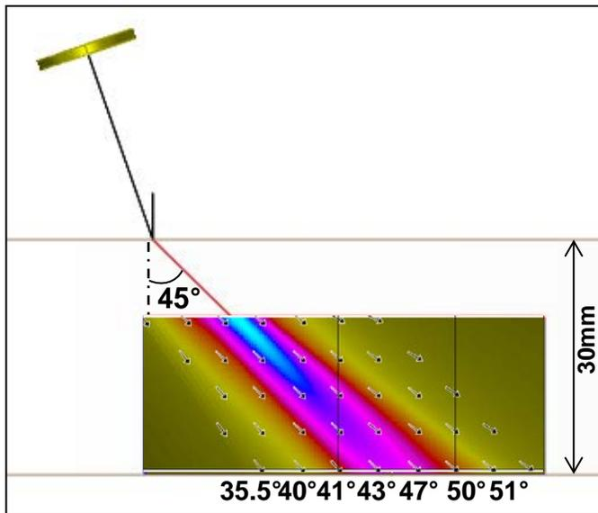
Immersion probe  $\varnothing 6.35\text{mm}$  2.25MHz, SV45°
