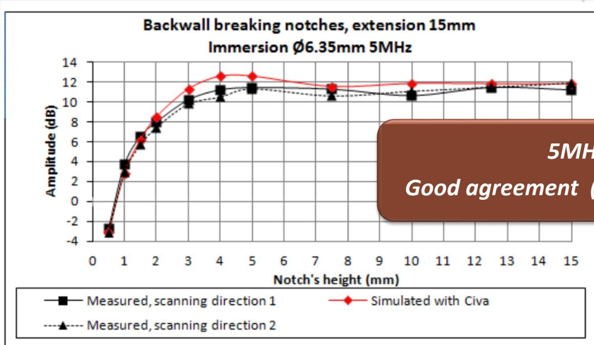
5MHz  $\varnothing 6,35\text{mm}$  probe
